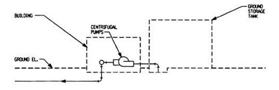
GROUND STORAGE TANK AND PUMP STATION (SECTION)
